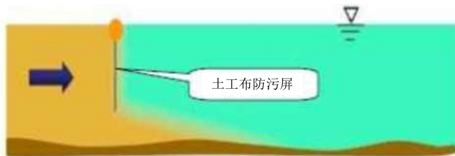
图 9.1-5 土工布防污屏防污机理示意图
